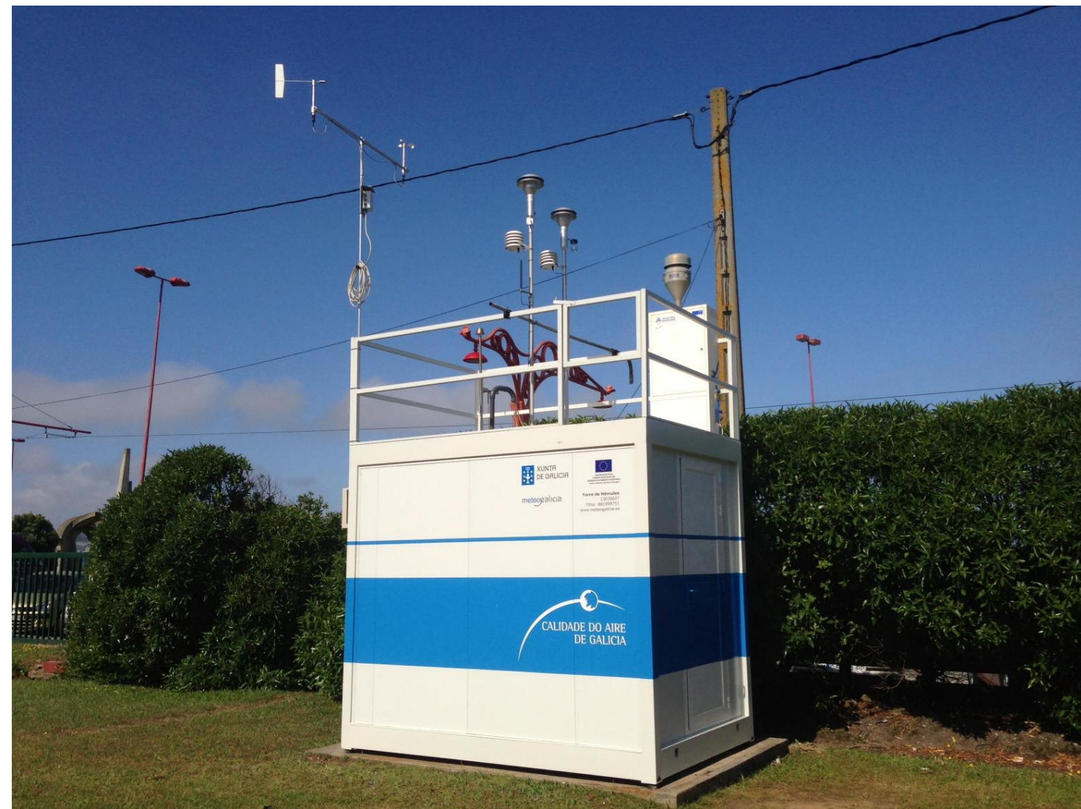
Captador gravimétrico Digital DHA-80 en estación de fondo urbano A Coruña (Torre de Hércules)
